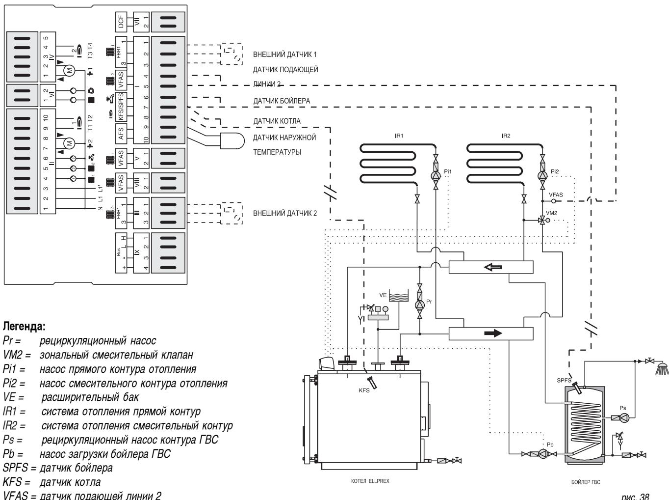
Дополнительная панель управления котла ELLPREX автоматически управляет выключением горелки, когда котел достигает температуры, заданной на терморегуляторе.
