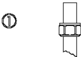
Пластиковая/медная трубы отрезать под прямым углом снять стружку/калибровать. надеть гайку на трубу.
