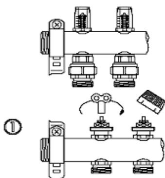
Снять защитный колпачок и закрыть вентиль ключом поворотом направо - это и есть самое маленькое значение.
