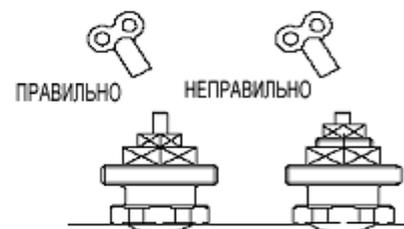
Тонкая резьба регулировочного шпинделя не должна выглядывать за пределы шестигранника SW 19! Вентиль следует открывать полностью закрытого положения поворотом влево до 2 1/2, 3 оборотов (полный расход).
