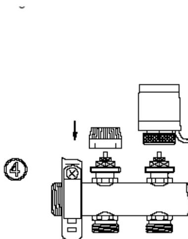
После окончания установки снова одеть защитный колпачок или сервопривод во избежание несанкционированного использования и попадания посторонних предметов.
