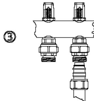
Предварительно смонтированную трубу вставить в резьбовое соединение.
